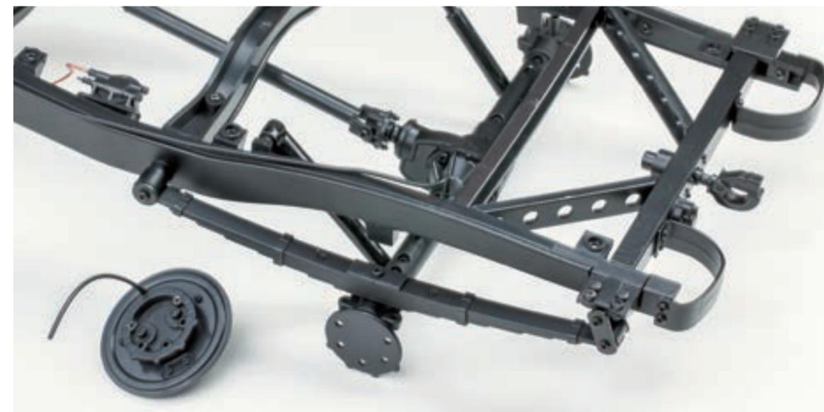
**Шаг 5.** Наденьте трубку заднего левого тормоза длиной 50 мм на штуцер тормозного цилиндра. Чтобы не сломать деталь, при монтаже трубки не прилагайте слишком больших усилий.
