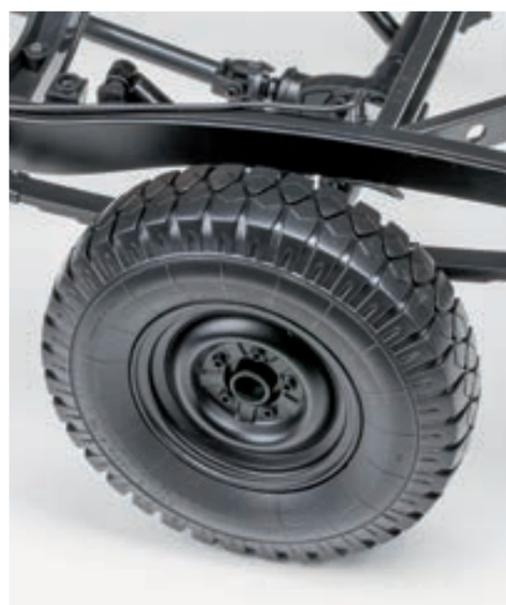
**Шаг 8.** Установите собранное ранее колесо на ось левого бортового редуктора заднего моста. При помощи шайбы и винта 2,3×5 (1М) закрепите колесо на оси.
