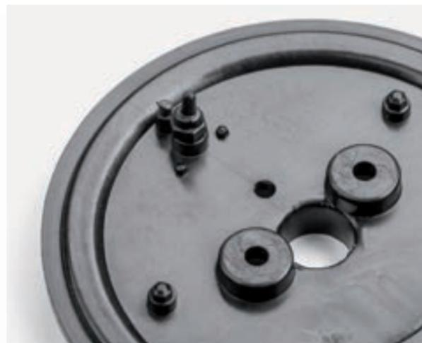
**Шаг 4.** Установите штуцер заднего тормозного цилиндра на тормозной щит заднего левого колеса. Обратите внимание: штуцер должен быть установлен в верхней части тормозного щита.
