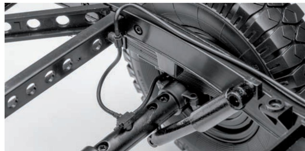
**Шаг 9.** Установите крышку поверх ступицы заднего левого колеса. Плотно прижмите детали друг к другу. Крышка ступицы должна войти в центральное отверстие диска колеса.
