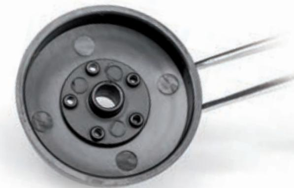
**Шаг 3.** Поместите собранные детали внутрь диска колеса таким образом, чтобы центральная часть ступицы оказалась на внешней стороне диска колеса. Закрепите установленные детали пятью винтами 2,0×7 (FM) с лицевой стороны диска.
