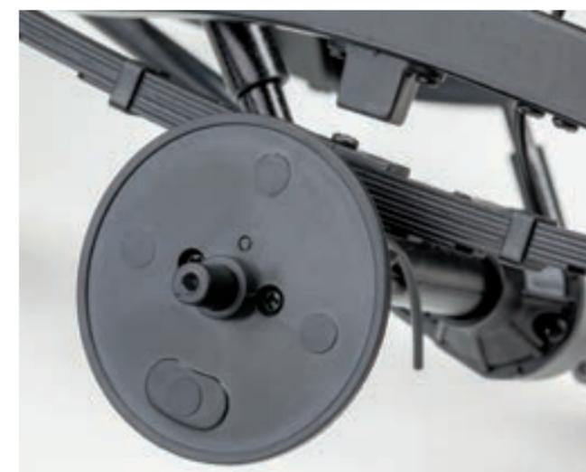
**Шаг 7.** Закрепите собранную крышку бортового редуктора на левом кожухе полуоси заднего моста. Для этого совместите крепежные отверстия деталей и зафиксируйте крышку бортового редуктора пятью винтами 2,0×4 (GM). Обратите внимание: для облегчения сборки в двух верхних отверстиях крышки редуктора уже присутствует резьба (на фото детали перевернуты).
