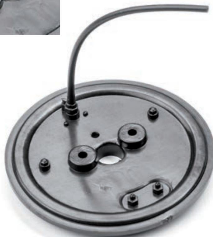
**Шаг 6.** Поместите крышку заднего левого бортового редуктора поверх тормозного щита, совместите центровочные элементы и закрепите детали двумя винтами 1,7×4 (СМ) с внешней стороны щита тормоза.
